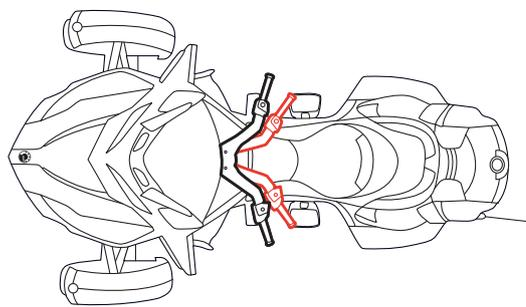
РЕГУЛИРОВКИ В ТРЕХ ПЛОСКОСТЯХ ПОЗВОЛЯЮТ ВЫБРАТЬ ВЫСОТУ И ШИРИНУ РУЛЯ, А ТАКЖЕ РАССТОЯНИЕ МЕЖДУ ВОДИТЕЛЕМ И РУКОЯТКАМИ.
