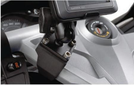
**КОМПЛЕКТ РЕГУЛИРУЕМОГО ДЕРЖАТЕЛЯ GPS-НАВИГАТОРА (ДЛЯ СТАНДАРТНОГО РУЛЯ)**
